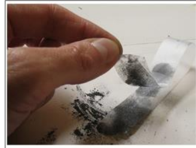
ภาพที่ 2 การใช้สก๊อตเทปในการลอกชั้นแกรไฟต์ให้บางลง
