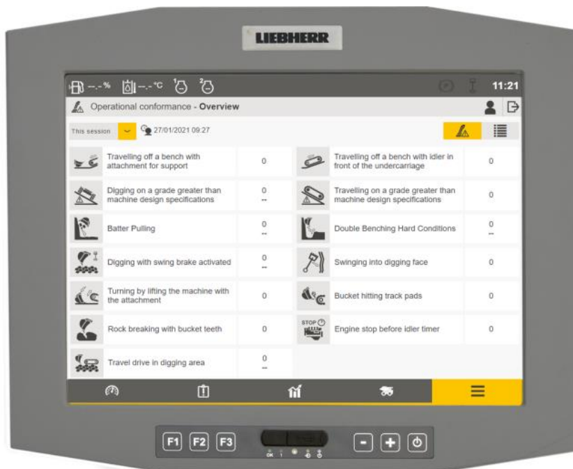
รูปที่ ๕ แสดงเหตุการณ์ที่ส่งผลกระทบต่อโครงสร้าง (Operational Conformance) ของรถขุดไฮดรอลิกรุ่น R 9600 ภาพจาก https://www.liebherr.com/en/int/products/mining-equipment/mining-excavators/r-9600/r-9600.html
