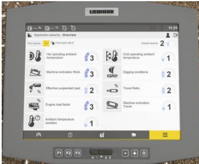
รูปที่ ๔ แสดงตัวชี้วัดความยากลำบากของสภาพงานที่ผ่านมา (Application Severity) ของรถขุดไฮดรอลิกรุ่น R 9600 ภาพจาก https://www.liebherr.com/en/int/products/mining-equipment/mining-excavators/r-9600/r-9600.html
