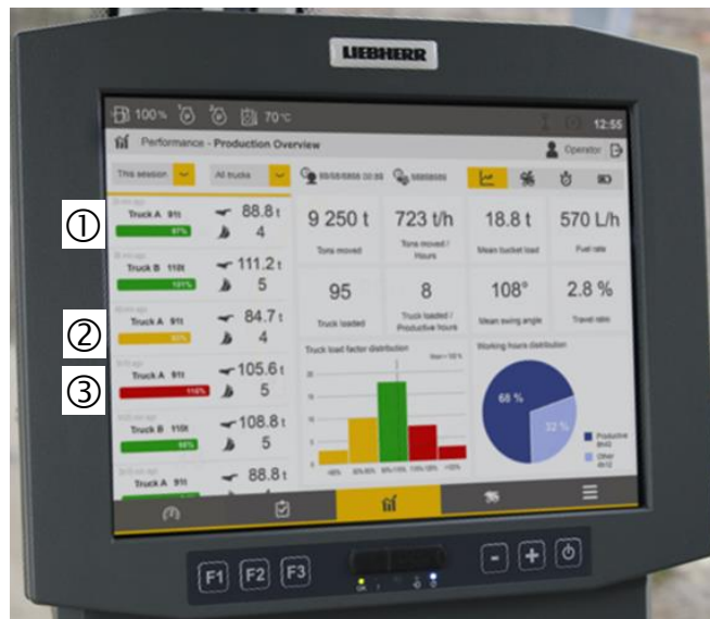
รูปที่ ๓ แสดงประสิทธิภาพการทำงาน (Production Performance) ของรถขุดไฮดรอลิกรุ่น R 9600 ของบริษัท Liebherr ภาพจาก https://www.liebherr.com/en/int/products/mining-equipment/mining-excavators/r-9600/r-9600.html
