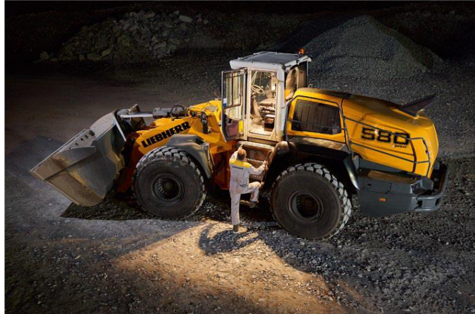
รูปที่ ๘ แสดงระบบล็อกประตูรถด้วยรีโมทคอนโทรล และระบบไฟส่องสว่างในห้องโดยสารเมื่อปลดล็อกประตูรถด้วยรีโมทคอนโทรลของรถตักล้อยางของบริษัท Liebherr
