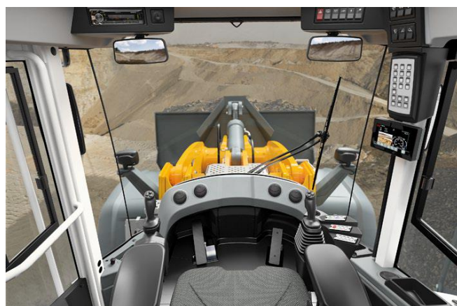
รูปที่ ๗ แสดงห้องโดยสารที่ไม่มีพวงมาลัยและแกนพวงมาลัยของรถตักล้อยางของบริษัท Liebherr
