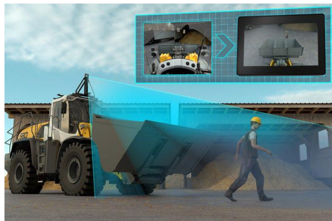
รูปที่ ๔ แสดงกล้องบนหลังคราดตักล้อยางของบริษัท Liebherr ภาพจาก https://www.liebherr.com/shared/media/construction-machinery/earthmoving/brochures/wheel-loaders/assistance-systems-for-the-liebherr-wheel-loaders/liebherr-radlader-ass.-us.pdf
