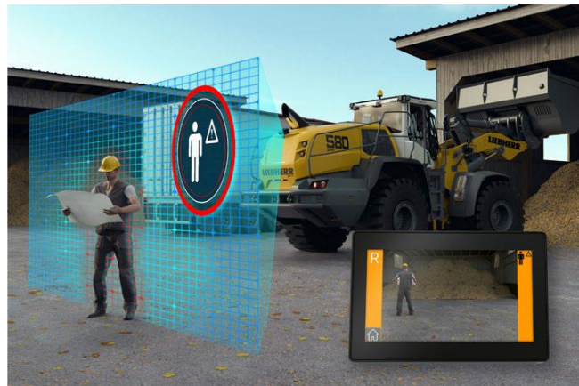
รูปที่ ๓ แสดงระบบตรวจจับบุคคลด้านหลังรถตักล้อยางของบริษัท Liebherr ภาพจาก https://www.liebherr.com/shared/media/construction-machinery/earthmoving/brochures/wheel-loaders/assistance-systems-for-the-liebherr-wheel-loaders/liebherr-radlader-ass.-us.pdf
