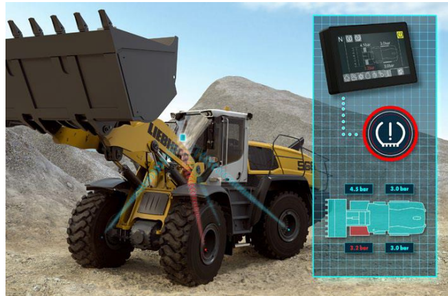
รูปที่ ๕ แสดงระบบตรวจสอบความดันลมยางของรถตักล้อยางของบริษัท Liebherr
