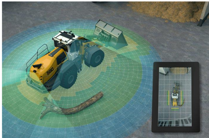
รูปที่ ๙ แสดงภาพมุมมองสูง ๓๖๐ องศาของรถตักล้อยางของบริษัท Liebherr
