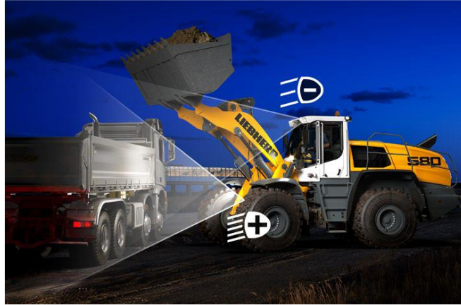
รูปที่ ๒ แสดงการปรับแสงสว่างของไฟส่องสว่างด้านหน้าและด้านบนห้องโดยสารของรถตักล้อยางของบริษัท Liebherr ภาพจาก https://www.liebherr.com/shared/media/construction-machinery/earthmoving/brochures/wheel-loaders/assistance-systems-for-the-liebherr-wheel-loaders/liebherr-radlader-ass.-us.pdf
